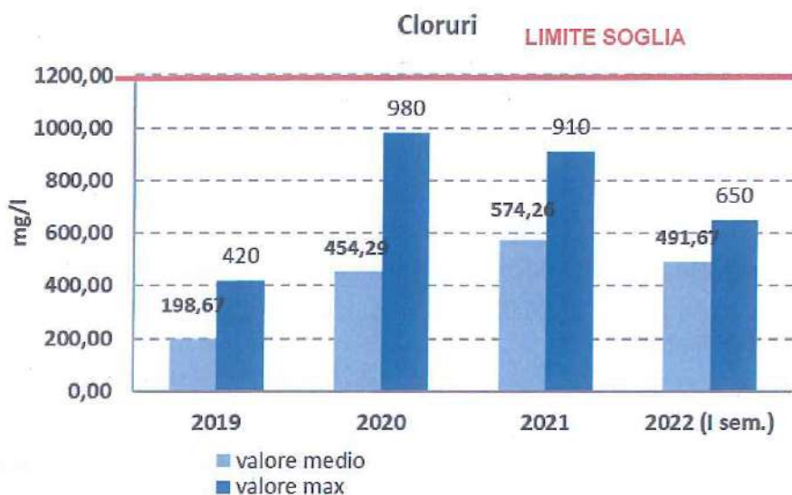
Grafico 17: andamento dal 2019 al primo semestre del 2022 dei valori dei cloruri nelle acque di scarico.
